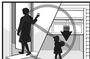
Ko uporabljate gumb, montiran na steni ali oddajnik, **nenehno glejte garažna vrata, dokler se ne zaprejo do konca.**
